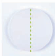
Variolink Esthetic Suntest (acc. a ISO 4049), Lado izquierdo expuesto al sol
